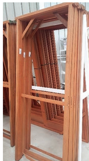
FIG. 46 WOODEN DOOR FRAMES
