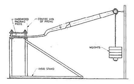
FIG. 6 BEND TEST OF FORKS
