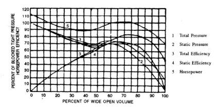
TYPICAL OPERATING CHARACTERISTICS OF A VANE-AXIAL-FLOW FAN
