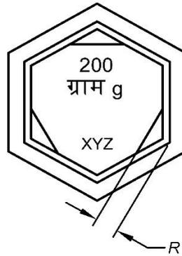
FIG. 2 CAST IRON OR FORGED MILD STEEL WEIGHT
