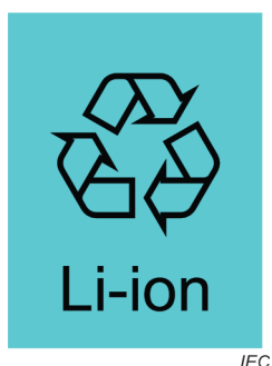
Figure 9 – Exemple de marquage des batteries ion-lithium avec symbole de recyclage
